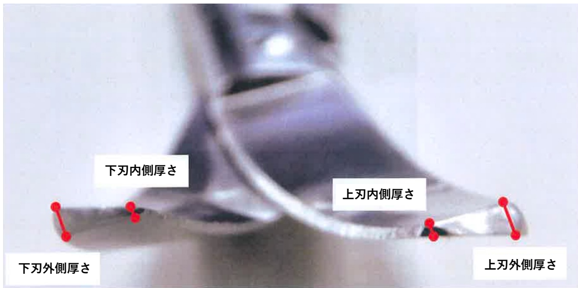
図 6 刃先の計測箇所
